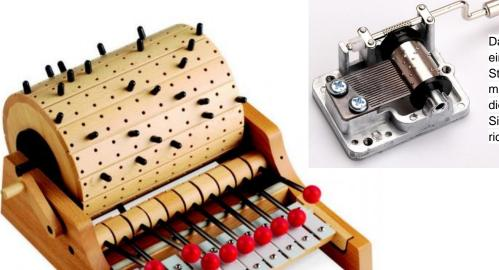
Das Gloggomobil ist nach dem Prinzip einer Spieluhr gebaut. Die schwarzen Stifte in den Löchern der Walze heben mit einem einfachen Drehmechanismus die Hämmerchen und lassen sie (im Sinne der programmierten Melodie) zum richtigen Zeitpunkt fallen.
